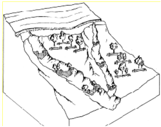
通过截排水沟、木谷坊、石坎梯田和栽树的错开排列的土坎等综合措施进行沟道控制和流域治理（玻利维亚科恰班巴地区）（绘图： Mats Gurtner）
